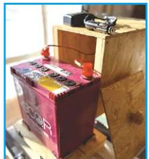
**[ポイント]** ①バッテリーは使用前に汚れを拭き取り、しっかり充電しておきます。②バッテリー本体は重量があるので、片手で持てるよう手提げを付けます。③ソケットの抜き差しは負担がかかるので、トグルスイッチを装着。④直流なので間違えないように専用ケーブル(赤黒)を使うことをおすすめします。
